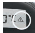
Signal d'avertissement en cas d'accumulation de la chaleur
