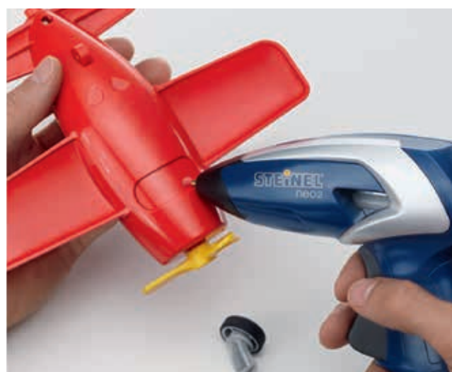
Assembler. Réparer rapidement un jouet en plastique avec de la colle à chaud.
