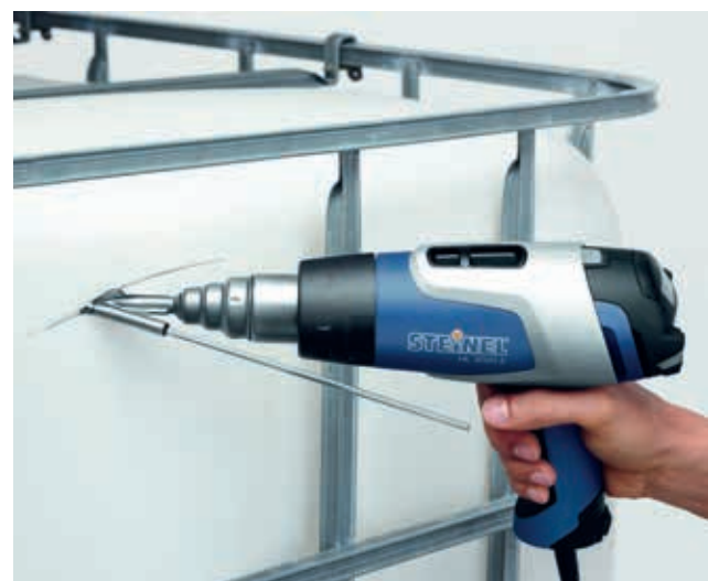
Réparer. Souder un réservoir d'eau en PVC.
