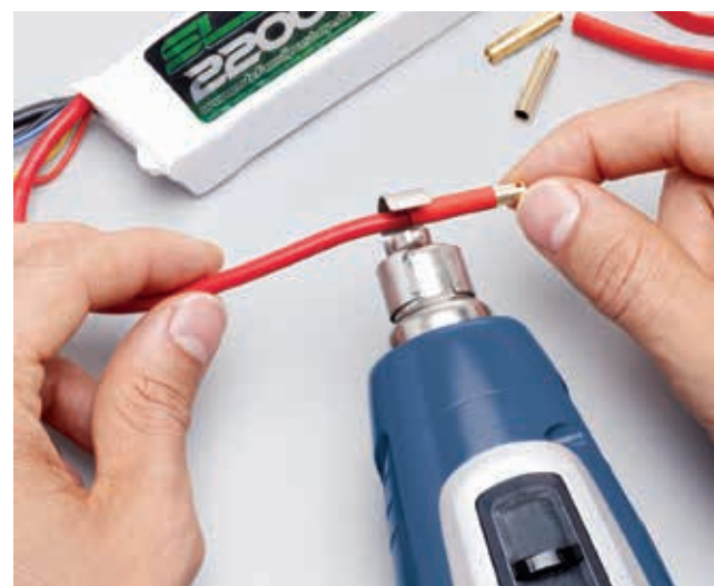
Rétracter. Des mains libres grâce à la surface de repos stable.
