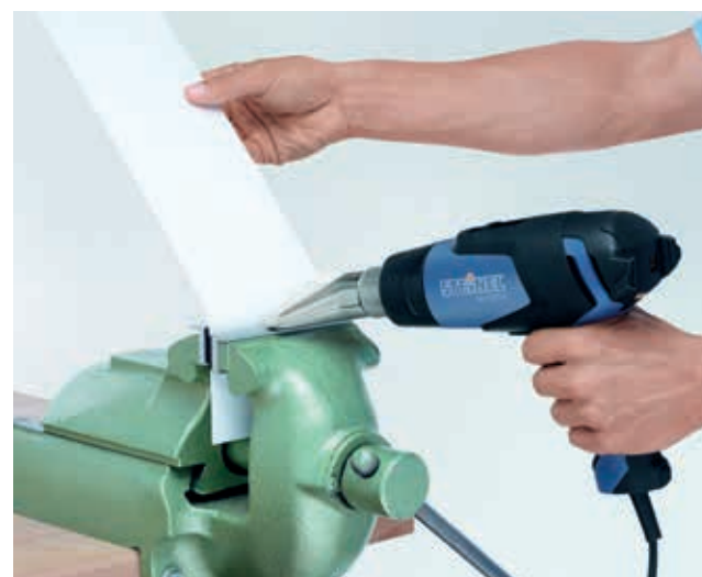
Thermoformer. Faire prendre la forme souhaitée au plastique de manière contrôlée sous l'effet de la chaleur.
